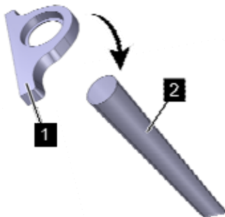
Abb. 2: Stopfen auf Lichtleiter schieben
